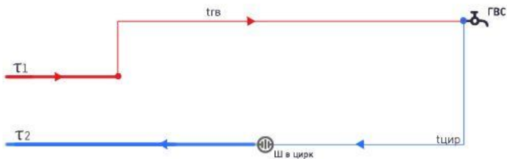
Рис. 3.12. Схема № 23. Потребитель с параллельным подключением подогревателя ГВС и насосным присоединением СО (насос на перемычке)
