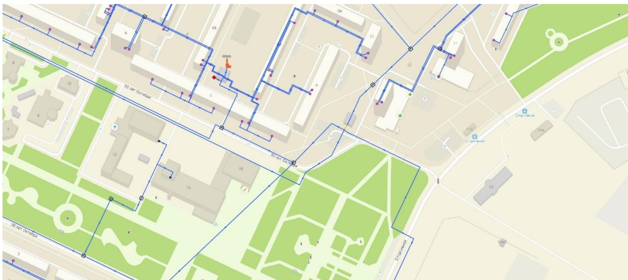
Рис. 3.28. Участок переключений в районе улиц Гагарина – Спортивная – 50 лет Октября между Тепловодом 2 (Город-2) и Тепловодом 3 (М-3)
